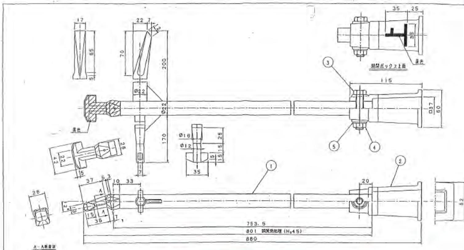
※消火栓にスタンドパイプを接続した状態で、消火栓の有効な開閉操作ができる長さとすることができる。
